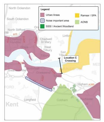
FIGURE 2.8 - CROSSING LOCATION SHOWING URBAN AND ENVIRONMENTAL CONSTRAINTS
